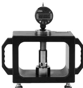
Die Messvorrichtung CMT 001 ermöglicht höchste Genauigkeiten bei der Messung der Restbodendicke bei gleichzeitig einfachster Handhabung. Die Messgenauigkeit beträgt  $\pm 0,01$  mm. Die hohe Messgenauigkeit ergibt sich durch den geschlossenen Aufbau der Messvorrichtung und fest eingebauter Messuhr. Einflüsse auf das Messergebnis durch manuelle Handhabung eines Messinstruments werden dadurch vermieden.
